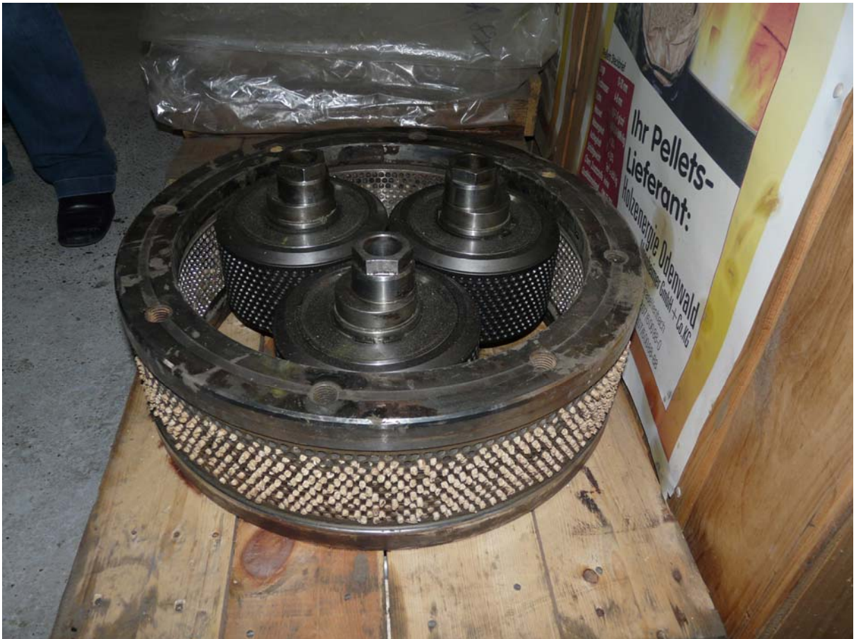
Matritze zur Herstellung von Holzpellets. Bei Verwendung von Miscanthus müssten die Matritzenbohrungen länger sein.
